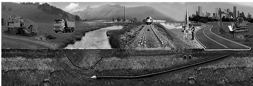
Рис. 23. Метод горизонтально направленного бурения
