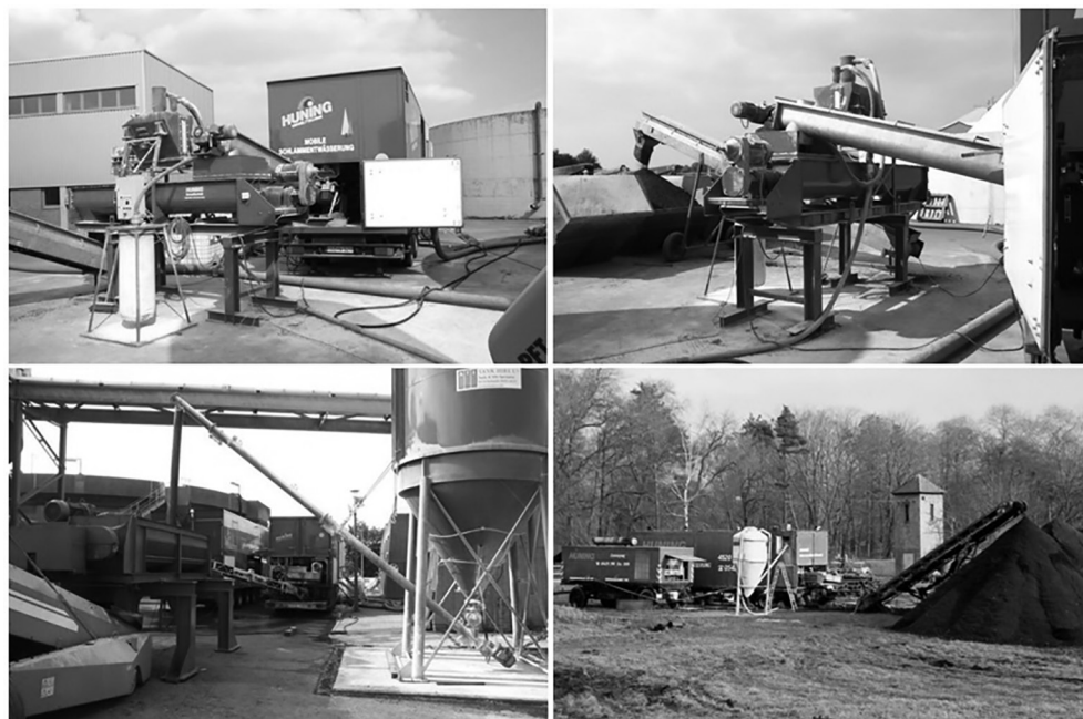
Рис. 2. Мобильный технологический комплекс по обработке биошлама
