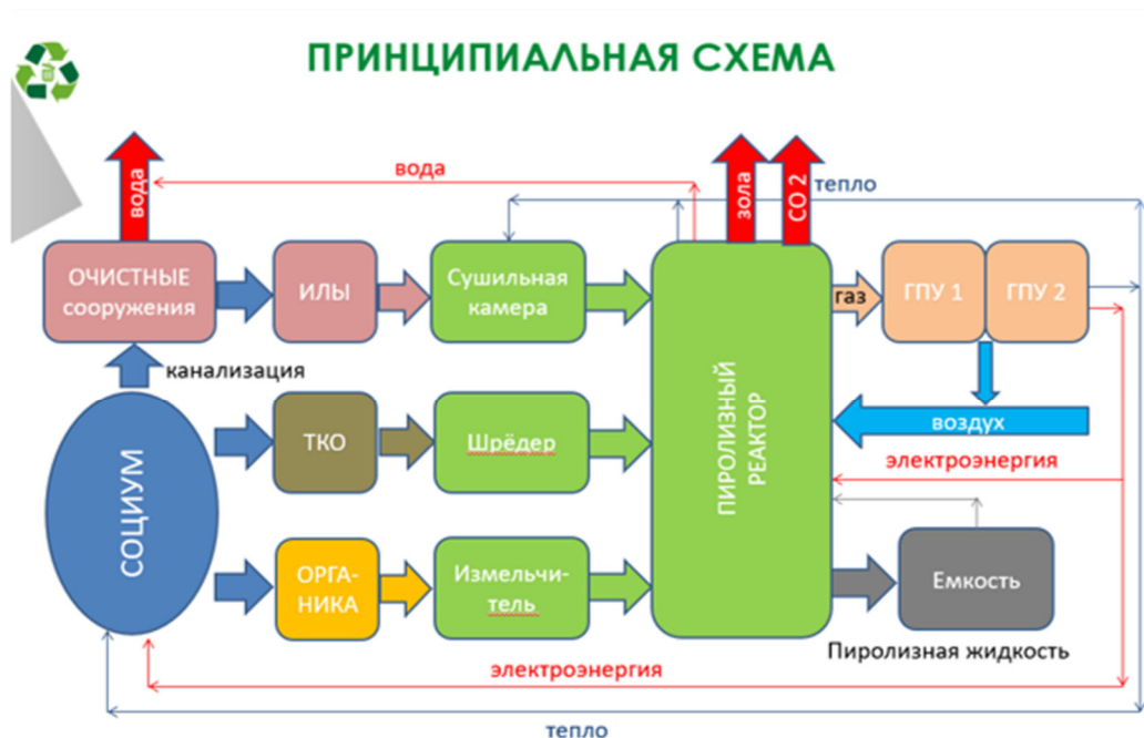
Рис.2. Схема технологических процессов на оборудовании Машиностроительного завода «МАЯК»
