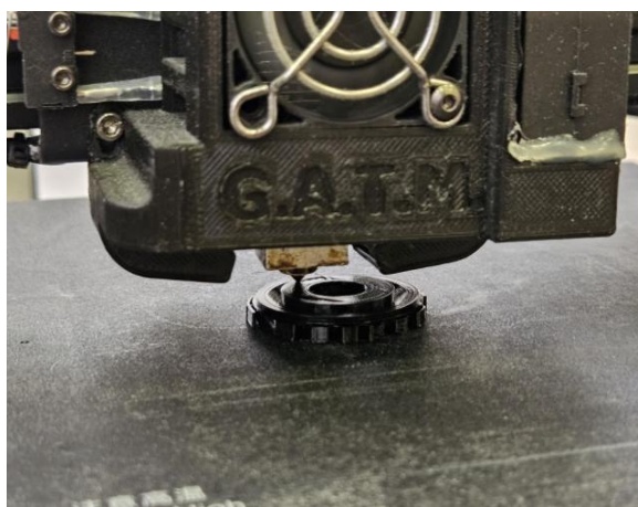
Рис.14 Печать детали на 3D принтере
