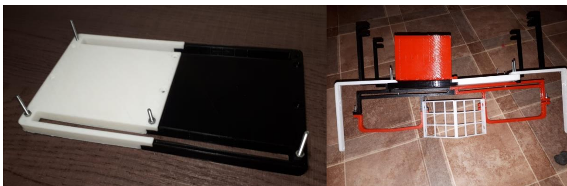
Рисунок 13. Твердотельная деталь – корпус прототипа, изготовленный из пластика PLA.
