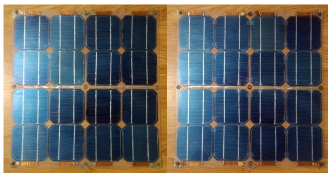
Рисунок 14. Фотоэлектрический модуль с двусторонними фотоэлектрическими монокристаллическими преобразователями (виды с двух сторон).
