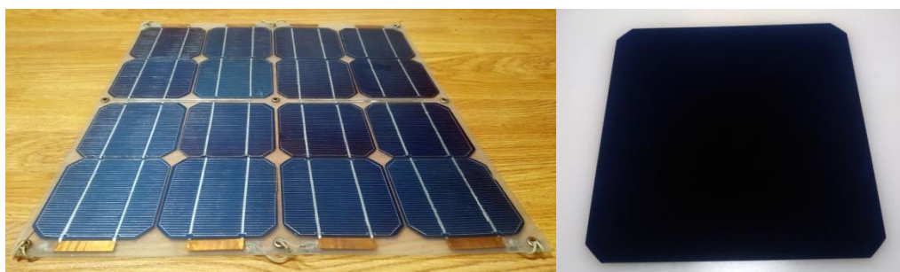
Рисунок 2. Двусторонний фотоэлектрический модуль (слева) и высокоэффективный фотоэлектрический преобразователь (справа).
