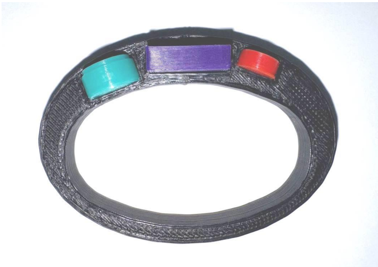
Рисунок Д - Расположения платы и других компонентов в браслете
