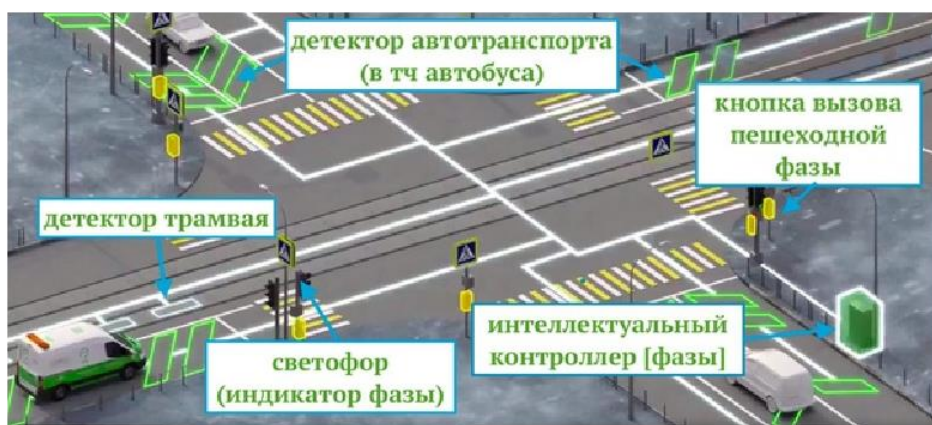
Рисунок 5 – Схема работы системы «Умный перекресток» в Москве 5 .
